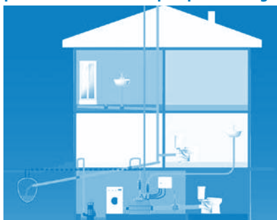
Figura 1: Esempio di installazione con pompa sommergibile:
